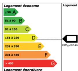
Le DPE est une estimation de la consommation énergétique d'un logement et de son taux d'émission de gaz à effet de serre. C'est une grille avec 2 étiquettes (exemple ci-contre) indiquant le résultat de l'évaluation par des échelons allant de « A » pour les logements économes jusqu'à « G » pour les plus énergivores. **Posez la question lors de la visite** : par souci écologique ou financier, cela peut être un critère de choix.
